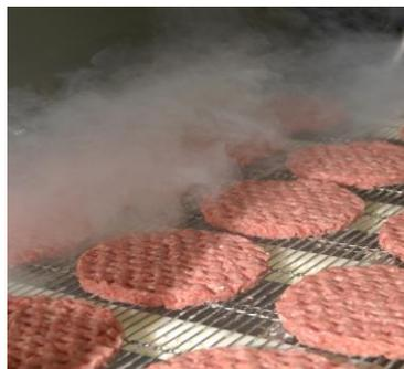
A través de la optimización del proceso en el túnel de enfriado se consigue reducir el consumo de nitrógeno.
